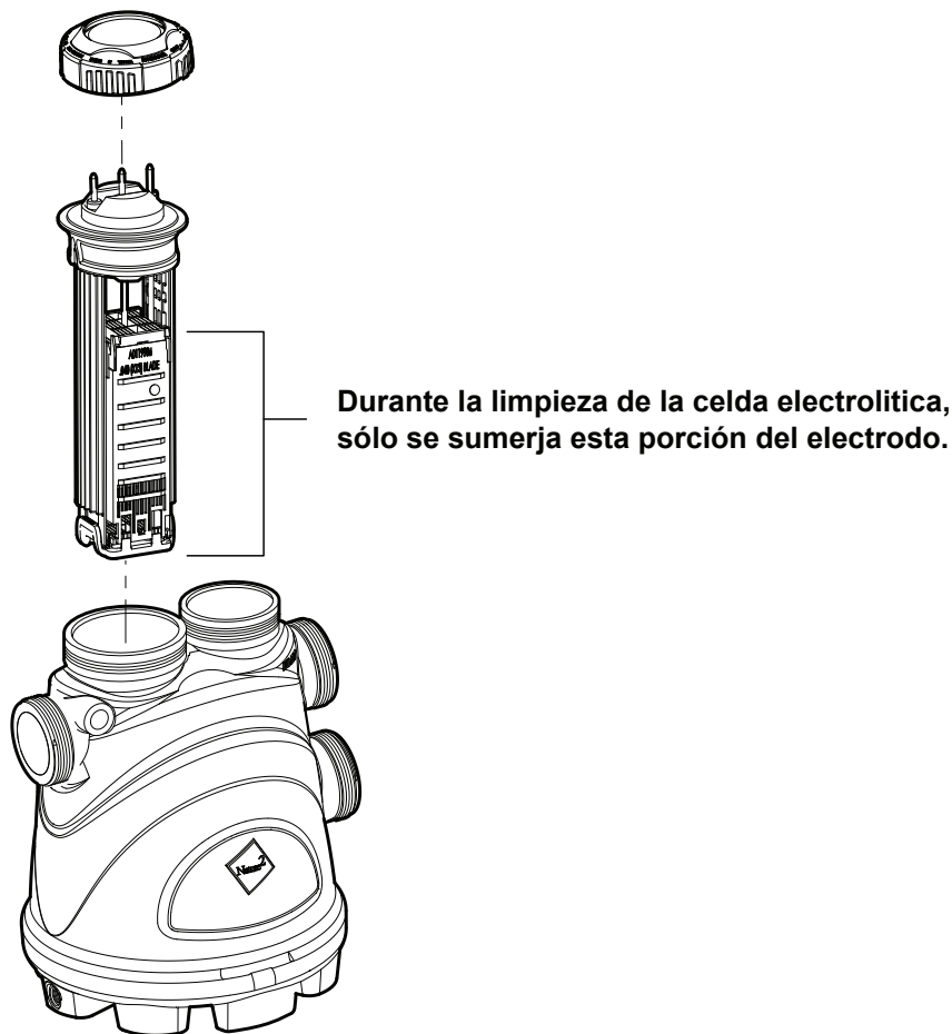
Figura 19. Limpieza de la celda electrolítica
