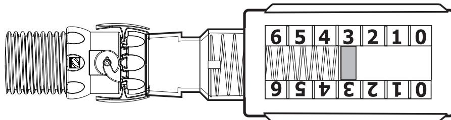
Au besoin, utilisez les valves dans le secteur d'équipement de la piscine pour ajuster l'écoulement que l'indicateur rouge est sur la configuration numéro 3.
