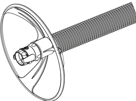
Fixez l'anneau en inserant l'extrémité du flexible du robot dans l'anneau extérieur, puis installez l'anneau en C sur le flexible.
