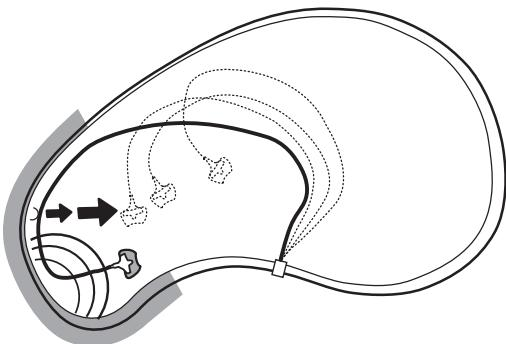
Puede usarse una línea de retorno para guiar el limpiafondos fuera de los escalones o de las áreas con esquinas en forma de V y reducir las franjas.
