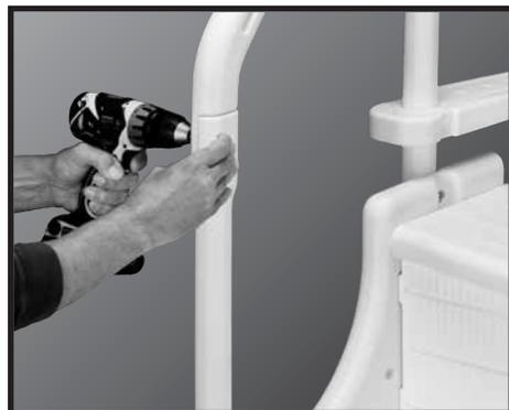
**Étape 3-6 :** Faites correspondre les encoches sur l'une des rampes avec les encoches des poteaux de rampe et fixez la rampe à l'aide de deux boulons 2-1/2" et de deux écrous hexagonaux 1/4" x 20.
