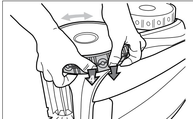
**Figure 40. Remettre le pneu sur la roue**
