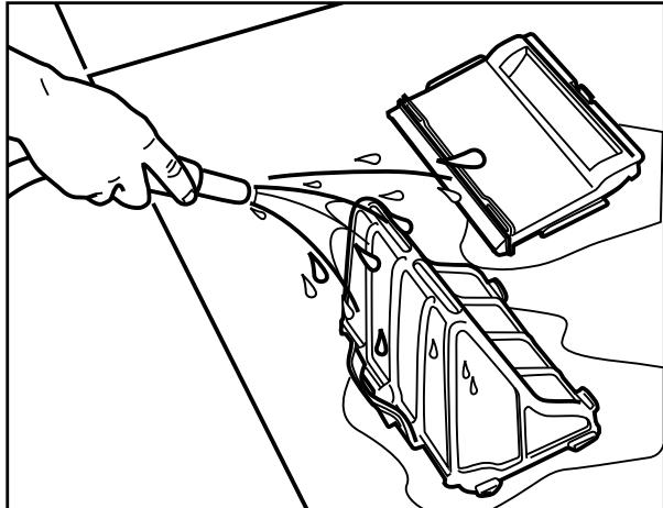
3. Saque el cartucho del filtro y enjuáguelo con agua limpia. Vuelva a conectar el cable en la unidad de control y guarde el limpiador para la próxima vez que se use.
