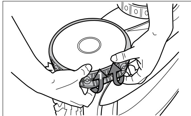
**Figure 35. Démonter le pneu usé de la roue**
