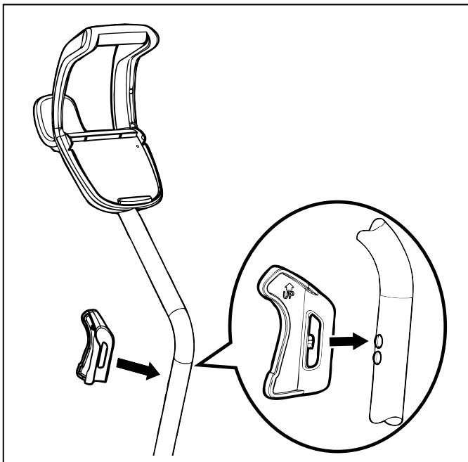
Figure 7. Mettre en place l'attache du robot nettoyeur
