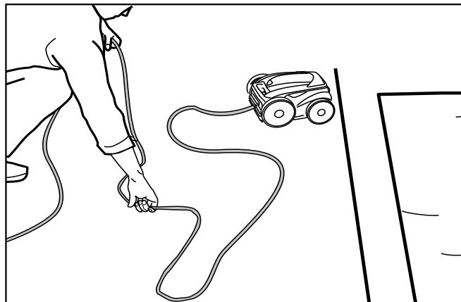
**Figura 22. Alise el cable de alimentación eléctrica**
