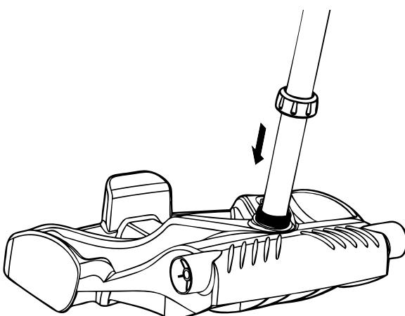
**Figure 4. Tourner l'écrou à main pour verrouiller le cadre**
