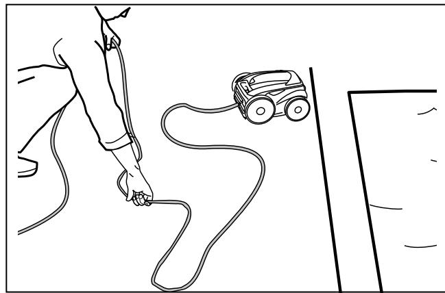
2. Retirer le nettoyeur de la piscine et démêler tous les plis et les noeuds dans le câble d'alimentation, en commençant par la tête du nettoyeur.
