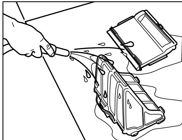
3. Retirer la cartouche filtrante et la rincer avec de l'eau propre. Rebrancher le cordon d'alimentation dans l'unité de contrôle et ranger le nettoyeur pour la prochaine utilisation.
