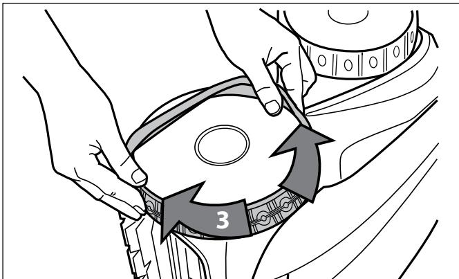
**Figure 39. Étirer le pneu autour de la roue**
