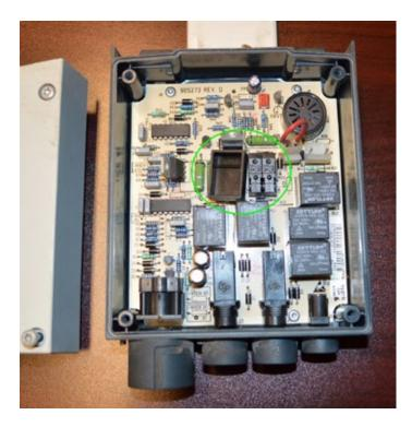
REMOVE THE COVER AND PLACE ON TABLE RIGHT-SIDE UP: NOTE POSITION OF EMERGENCY-SWITCH CAP
