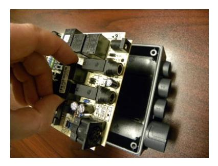
REMOVE THE CONTROL BOARD FROM THE CONTROL BOX
