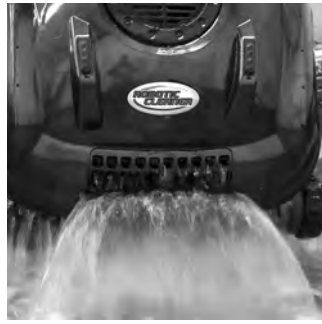
Abbildung 2 REINIGER AUS DEM POOL MIT DER HAND HEBEN
