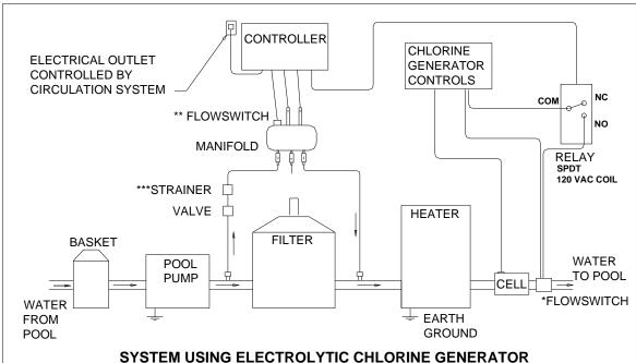
SYSTEM USING ELECTROLYTIC CHLORINE GENERATOR
