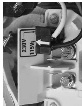
Figure 4B - Prise de changement de tension réglée pour le courant de 115 volts
