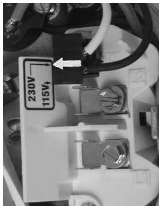
Figure 4A - Prise de changement de tension réglée pour le courant de 230 volts
