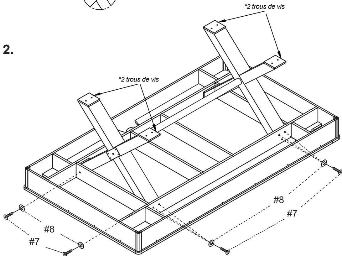
*\*Noter l'emplacement des trous de vis aux extrémités des jambes lors du montage des jambes*
