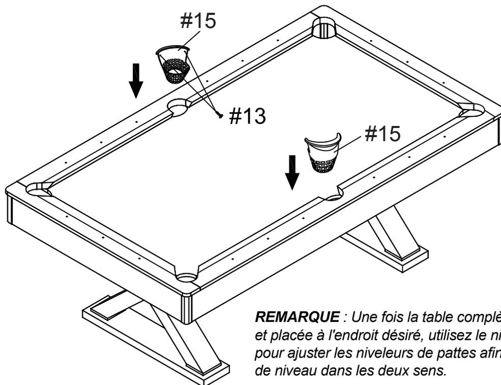
**REMARQUE :** Une fois la table complètement assemblée et placée à l'endroit désiré, utilisez le niveau (non inclus) pour ajuster les niveleurs de pattes afin que la table soit de niveau dans les deux sens.
