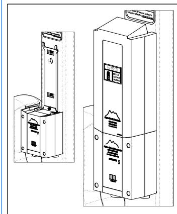
7 REMOVE THE FULLY CHARGED BATTERY FROM THE CHARGER AND INSTALL THE BATTERY TO THE CONTROL BRACKET, ON TOP OF THE CONTROL BOX. ONCE SECURE, CONNECT THE BATTERY CABLE TO THE CONTROL BOX CABLE. THE LIFT WILL ONLY OPERATE WHEN THE BATTERY IS CONNECTED PROPERLY.
