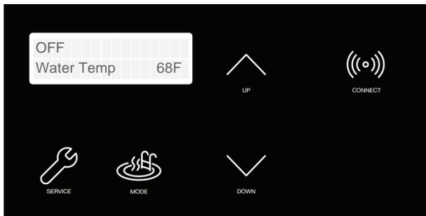
Figure 89. Réinitialisation du Wi-Fi – maintenez la touche CONNECT enfoncée
